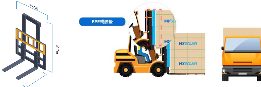
叉车门架：高≥1.7M,宽≥1.5M，叉车门架前置 EPE 或胶垫等缓冲材料
