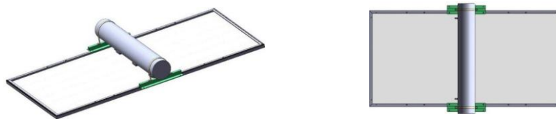
单轴跟踪系统组件安装示意图
