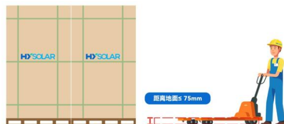
液压叉车周转叉齿高度要求示意图
